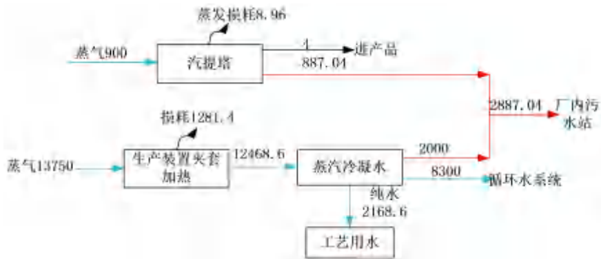
图 3.4-2 本项目蒸气平衡图 m 3 /a
