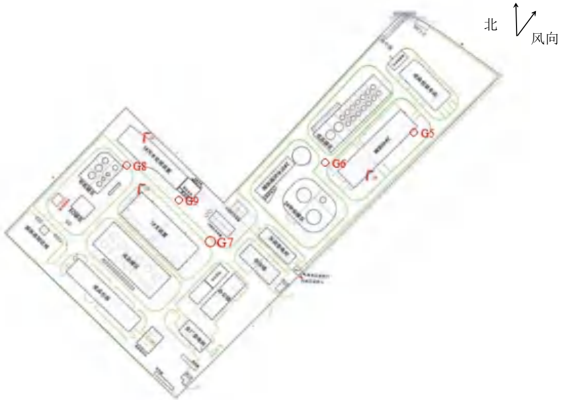
图 7.2-3 厂内无组织废气监测点位图（2022 年 7 月 27 日）
